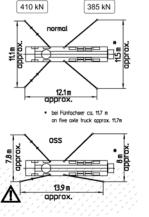
bei Fünfachser ca. 8.1 m on five axle truck approx. 8.1m
